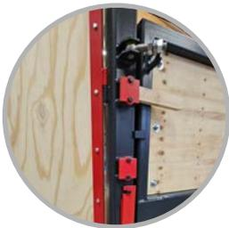
Schiene zum Anschrauben einer Platte zur Hauswand- /Treppentraumsimulation.
