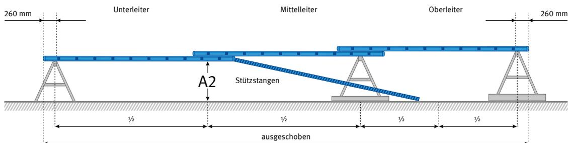
Abb. 14 Unbelastete, ausgeschobene Schiebleiter mit Prüflasten
