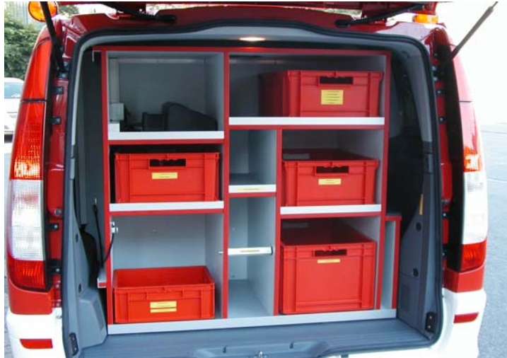
Heckregal, mit verstellbaren Einlegeböden und Kunststoffkästen zur Aufnahme der Norm- und Zusatzbeladung.
