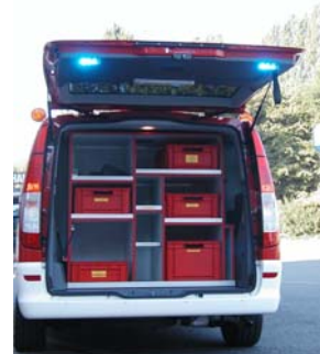
Doppelblitz-Blaulichtanlage in Heckklappe montiert
